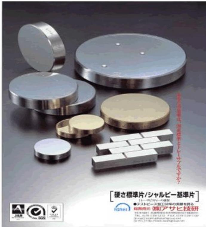
硬さ試験は、機械部品や熱処理製品の強度を評価するための簡易的な方法として広く用いられています。その硬さ試験機を校正するために用いるのが硬さ標準片です。また、衝撃試験機を校正するために用いるのが衝撃試験機用基準片です。1988年に硬さ、衝撃、引張りなどの強度試験機を校正するための基準片の開発に取り組み、1991年米国で開催された田口メソッド国際シンポジウムで硬さと衝撃基準片の開発に関する研究発表を行い金賞を受賞しました。それを機に硬さ標準片と衝撃基準片の製造販売を行っています。
