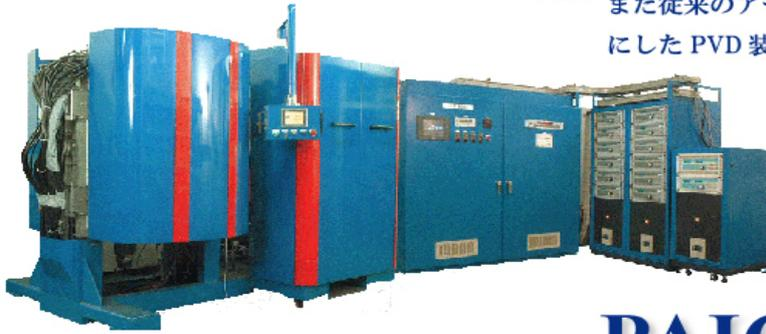
**本**装置は、多元素膜・複合膜への対応を可能にし、また従来のアーク方式によりも面粗度の向上も可能にしたPVD装置です。成膜速度についても4面カソードを採用することにより処理速度を短縮する
